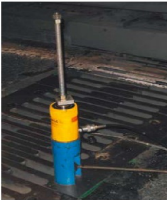
Illustration 60 : Serrage ou mise en tension des ancrages.
