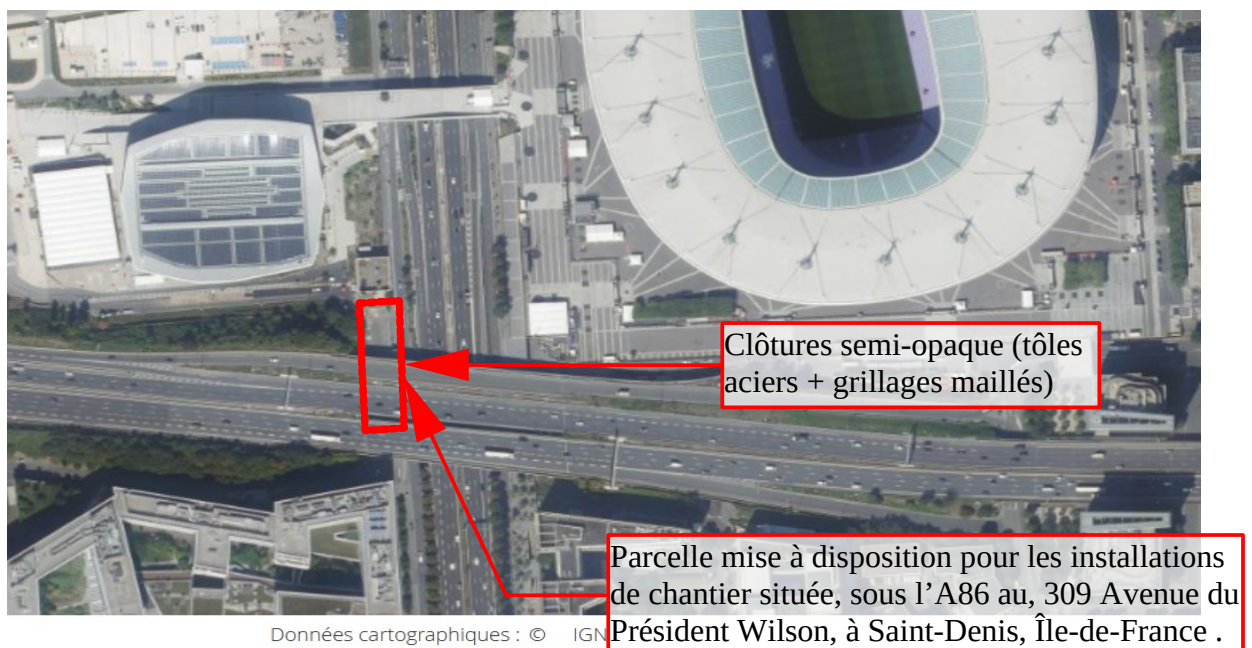
Illustration 65 : Les installations de chantier
